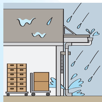
縦樋の接続部から溢水し浸水
