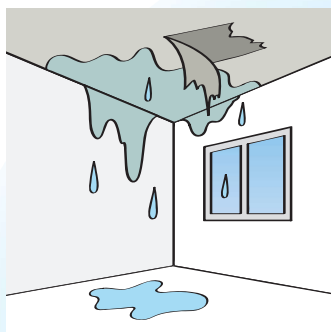
天井にシミ及び剥離が発生
